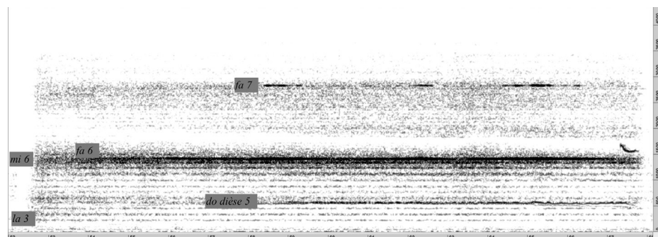
FIG. 7 : Sonagramme du son de saxophone qui a été trouvé à partir du son électronique précédent. (Le saxophoniste joue la note fondamentale à l'unisson avec l'électronique et cherche des résonances dans le son fondamental afin d'enrichir l'électronique.) [Logiciel Audiosculpt 3.4.6. ; type d'analyse : FFT ; fréquence d'échantillonnage : 44100 Hz ; Window Type : Hanning ; Oversampling : 2×.]
